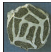
рис.3. Срез 5 жгутов Permacure®, которые, завулканизировавшись вместе, образовали единый монолит.
