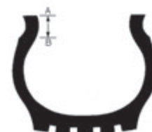
A-B - Неремонтируемая зона
